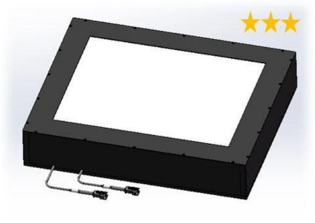
CCS 凭借多年来在机器视觉光源行业的技术积累，成功开发出专门用来校准相机以及镜头的标准光源。光源特点：1.亮度均匀，均匀度大于 95%。2. 采用独特自然光全光谱 LED 颗粒，实现了光源的高显色性，显色指数大于 95。3. 在实现上述两点的基础上，白光光源色温从 2800K 到 6500K 连续可调。4.光源发光面大小可定制。
