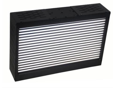
程控条纹光源主要是用于产生横竖交替的条纹图形和其他的可用于光学投影相位测量的图形。本光源可自由调节条纹宽度和图像偏移步距, 实现图像 N 帧偏移, 还可以自定义编辑条纹颜色以及显现流程, 实现自动化执行流程, 以及流程单步调试, 为光学投影相位测量提供灵活的图形显示。可应用于曲面测量、轮廓测量、平整度测量、缺陷检测等多方面检测场合, 也可应用于大型光滑物体的表面检测和外形轮廓的三维检测等, 应用面广泛。
